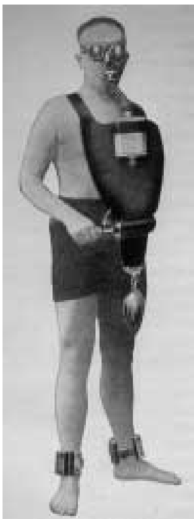
Fig.11 - ARO "Modello da Immersione" prodotto dalla ditta Bergomi di Milano negli anni 1930. E' interessante notare gli occhiali, lo stringinaso, il contenitore della calce sodata esterno al sacco, il peso applicato al sacco polmone e, soprattutto, i pesi alle caviglie per poter camminare più agevolmente sul fondale (dal "Catalogo Bergomi Soc. An. di Milano" del 1933).
